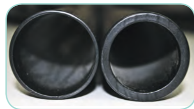
QUERSCHNITT EINER WINDSINGER-RÖHRE (RECHTS) UND EINER RÖHRE EINES ANDEREN WOODSTOCK-KLANGSPIELS (LINKS).
